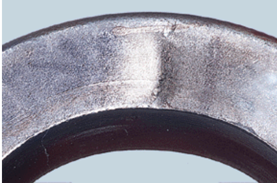
Ütésnyomok és horpadások
