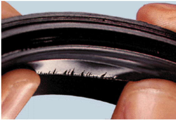
Hő okozta károsodás
