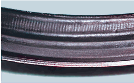
Nyomásnövekedés okozta kopás
